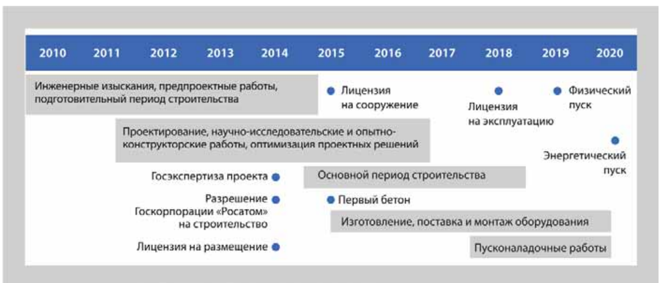
Рис. 4.2.8. Дорожная карта проекта по строительству реактора МБИР
