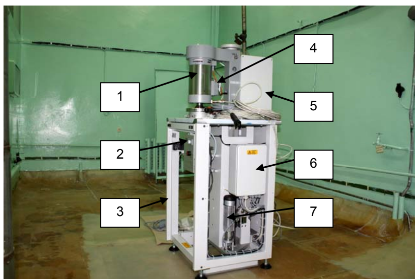
Общий вид установки для измерения температуропроводности: 1 – высокотемпературная трубчатая печь; 2 – блок измерения вакуума и газового потока; 3 – стойка; 4 – вентилятор; 5 – механизм перемещения печи; 6 – электрический щит; 7 – двигатель для подъёма/опускания печи
