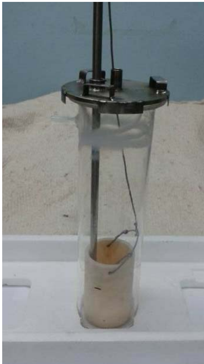
Общий вид аппарата растворения оболочки твэла с реальным нитридным ОЯТ в жидком цинке
