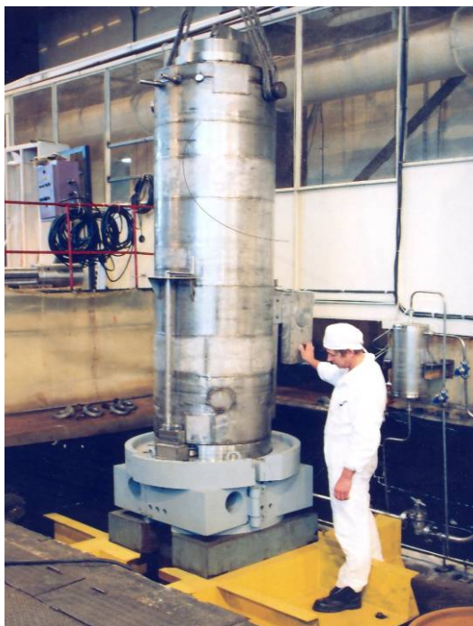
Стенд инспекции ОТВС
