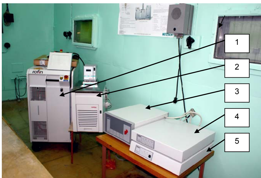
Общий вид системы управления и измерительной части установки для измерения температуропроводности: 1 – лазер высокой мощности SW040II; 2 – охлаждающий термостат с замкнутой циркуляцией; 3 – устройство, включающее блок питания и трансформатор; 4 – блок управления лазером; 5 – блок управления инфракрасным датчиком
