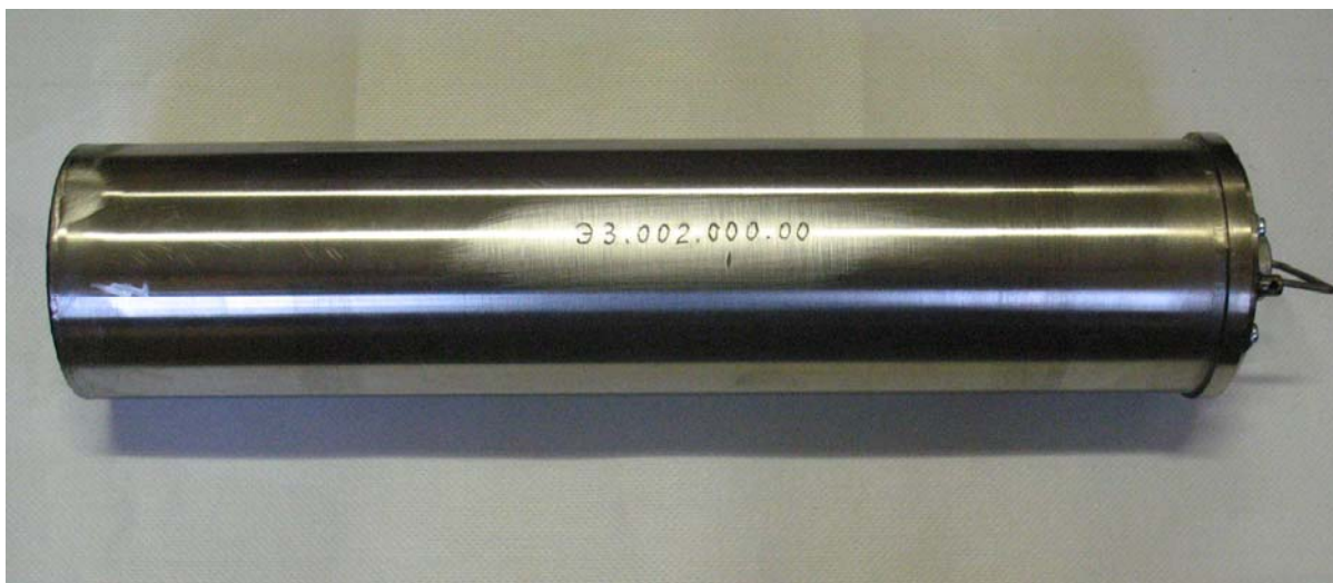
Общий вид защитного экрана для стабилизации чувствительности блока детектирования монитора нейтронного потока
