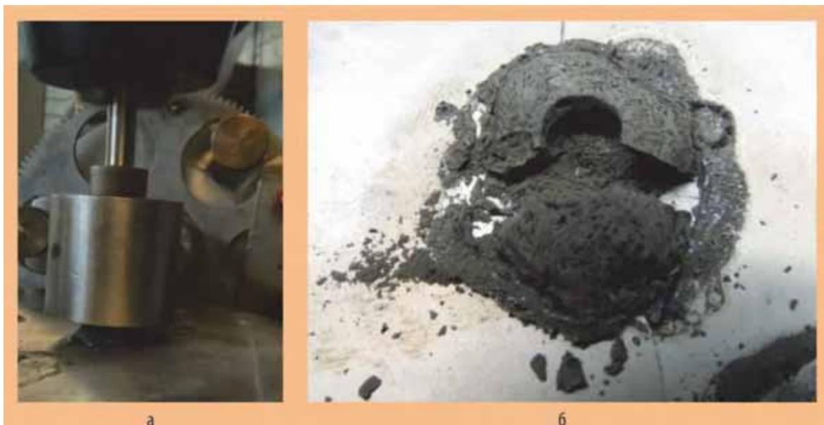
Рис. 3.15. Фрагментация твёрдосплавной фрезой (а) и внешний вид образца после обработки (б)
