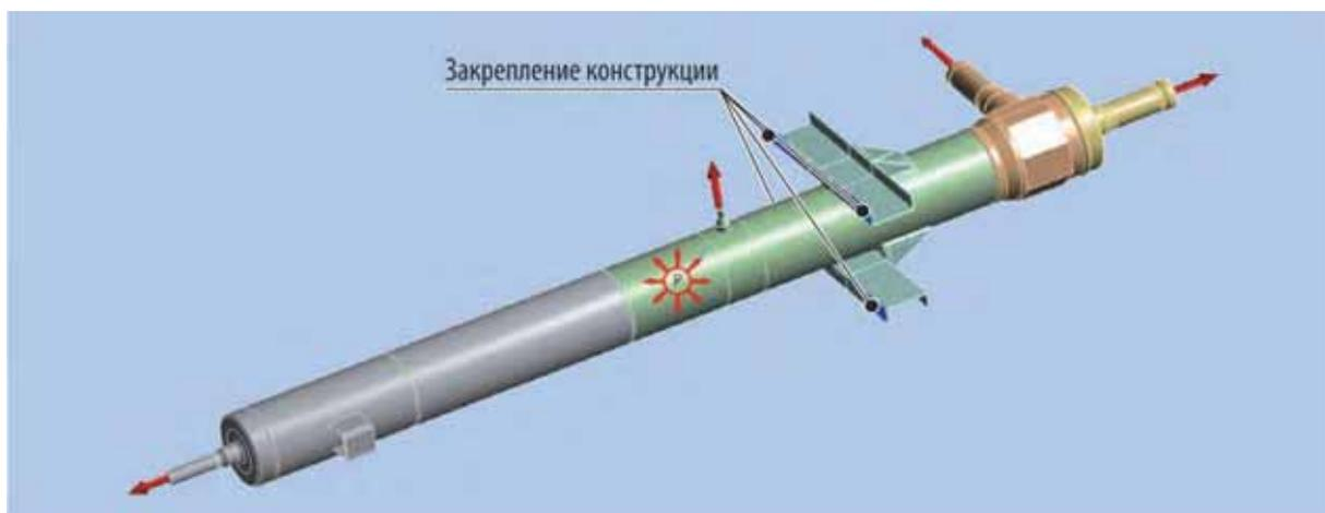
Рис. 1.30. Схема нагрузки и граничных условий расчётной модели сепаратора с указанием направления компенсирующих усилий от внутреннего давления  $P$  на патрубки
