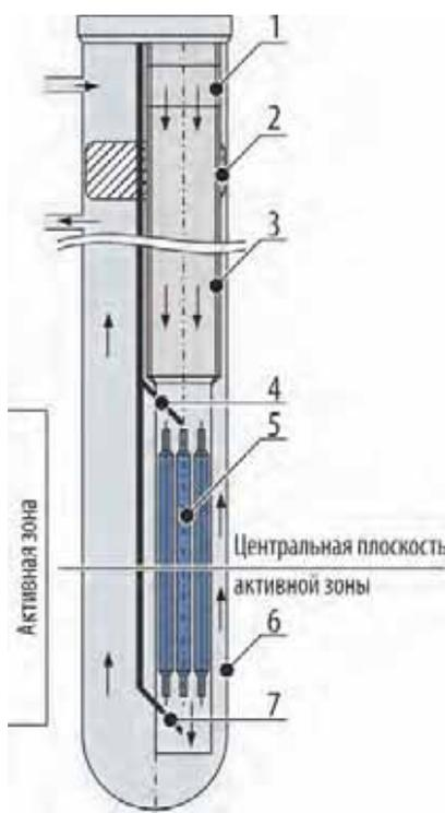
Рис. 1.24. Схема облучательного устройства с экспериментальной ТВС с указанием направления движения теплоносителя: 1 — окна для прохода теплоносителя; 2 — узел уплотнения; 3 — разделитель потока; 4 — термоэлектрический преобразователь на входе в рабочий участок; 5 — рабочий участок; 6 — корпус канала; 7 — термоэлектрический преобразователь на выходе из рабочего участка
