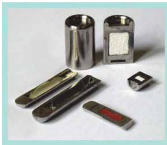
Рис. 6.3. Внешний вид источников ионизирующего излучения на основе кобальта
