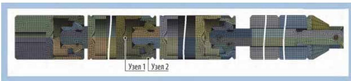
Рис. 1.48. Модель рабочих органов системы управления и защиты и расчётная сетка с указанием узлов с максимальными значениями амплитуды условного упругого напряжения
