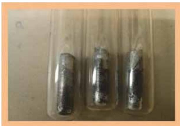
Рис. 3.19. Образцы сплава урана с кадмием
