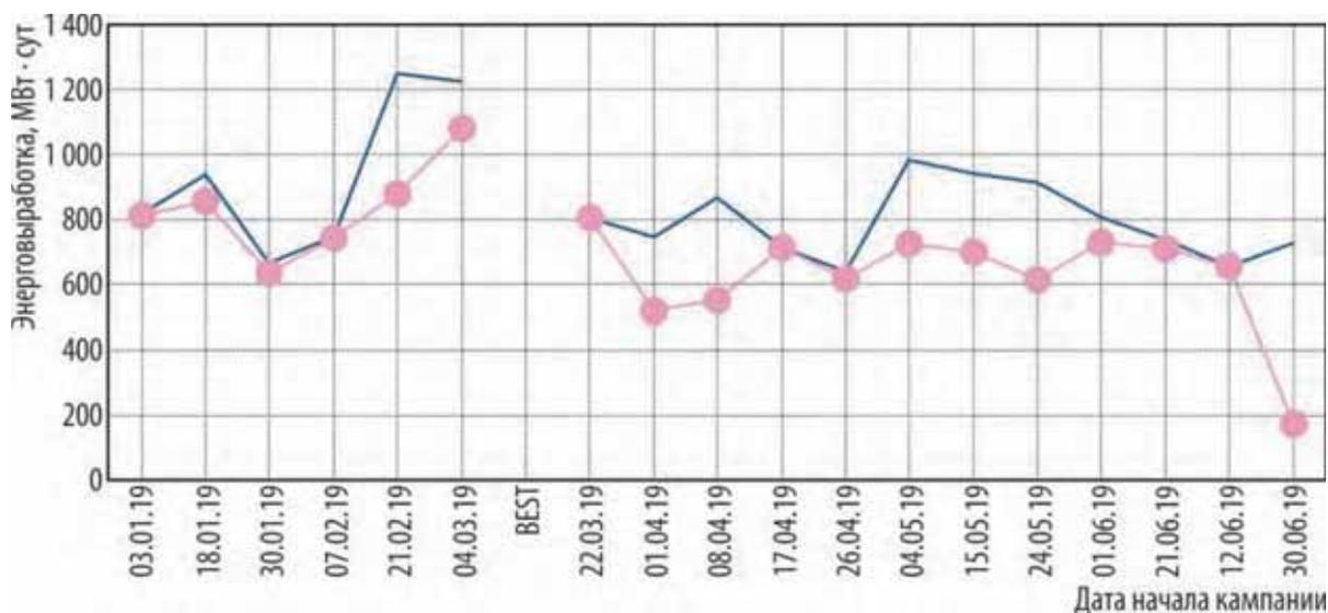
Рис. 1.43. Изменение энерговыработки реактора СМ за кампанию реактора (●) и по исчерпанию запаса реактивности (—)
