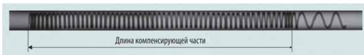
Рис. 2.12. Схема измерения длины компенсирующей части пружинного фиксатора
