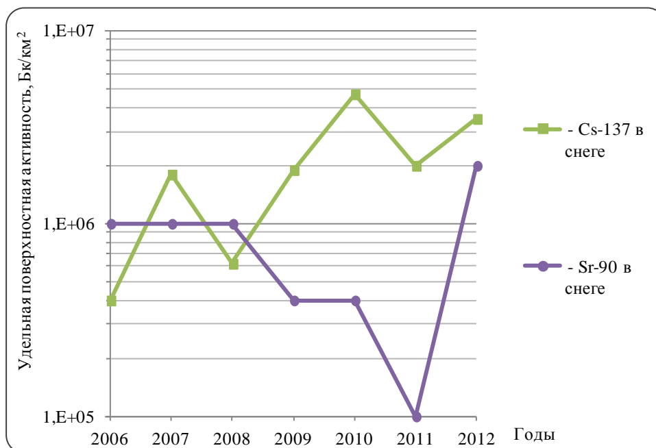
Рис. 15. Активность основных техногенных радионуклидов в почве и снеге в зоне наблюдения НИИАР
