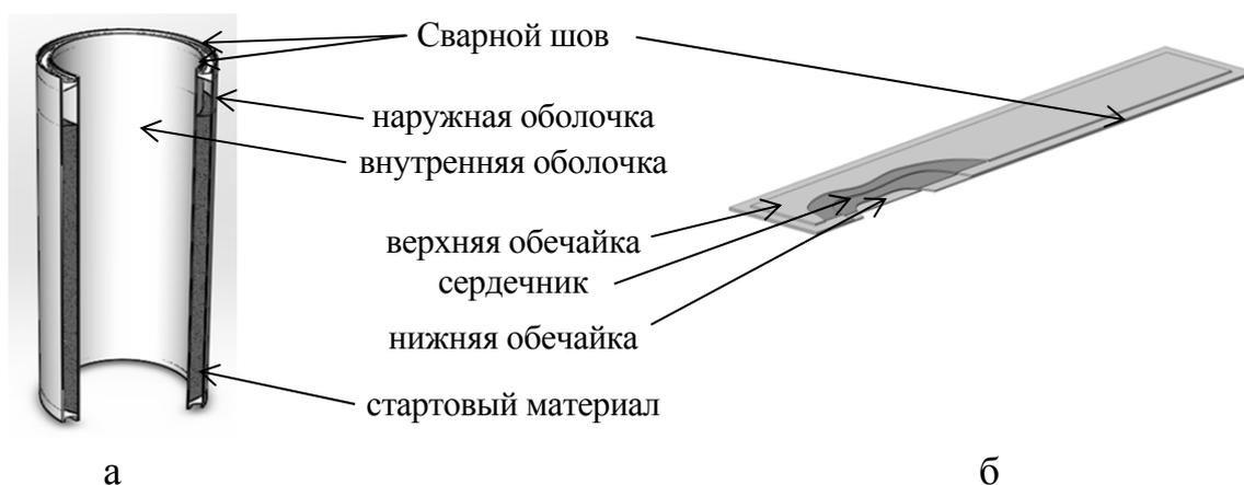
Рис 1. Конструкции облучательных мишеней для наработки  $^{99}\text{Mo}$
